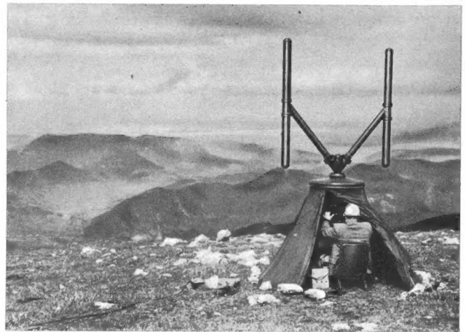
Er peilt in den Bergen: Der Ermittlung des genauen Standortes weitentfernter oder auch unbekannter UKW-Sender dient eine besondere, auf Bergen oder hohen Gebäuden stationierte Empfangs- und Peilanlage. Ein Tonbandgerät ermöglicht eine Dokumentation des mit der Anlage aufgenommenen Nachrichteninhaltes und das Einblenden von Beobachtungsmittlungen des Peilfunkers über ein Mikrofon (Aufnahme: Telefunken)
