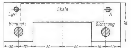
Bild 6. Maße des Chassisbleches
