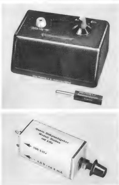
Bild 3. 100-kHz-Quarz-Eichpunktgeber von Funke. Oben: selbständiges Modell mit Batterie-Stromversorgung; unten: Einbau-Modell, Stromversorgung vom Hauptgerät
